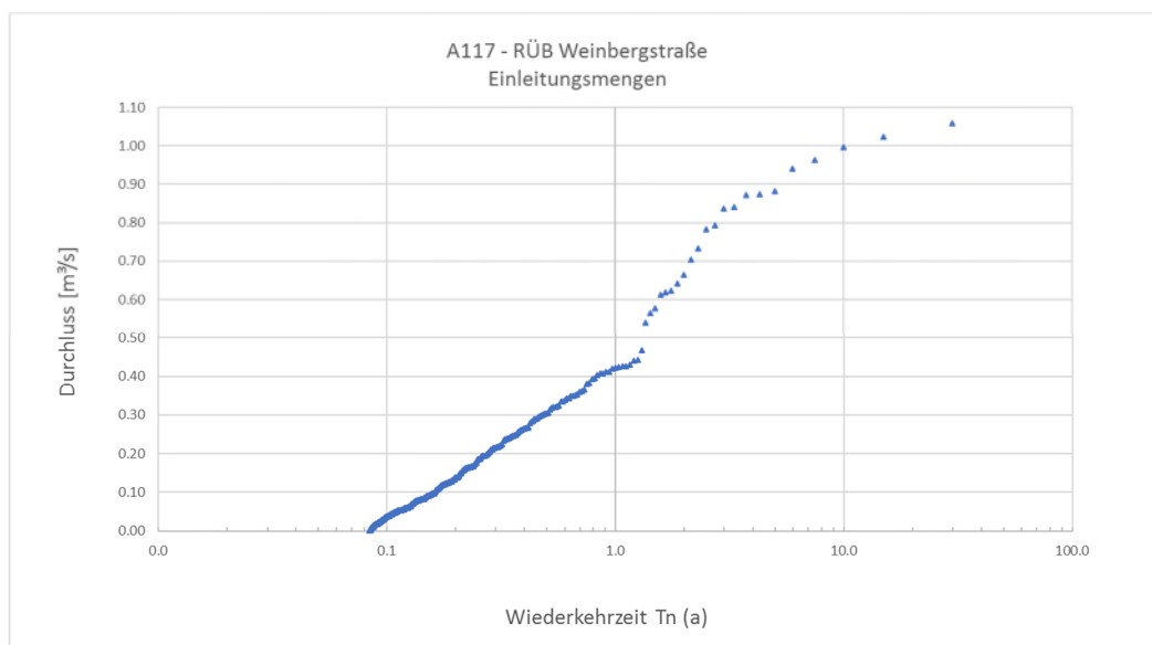
Abbildung 9: Auswertung der Durchflussmengen am Entlastungsbauwerk
